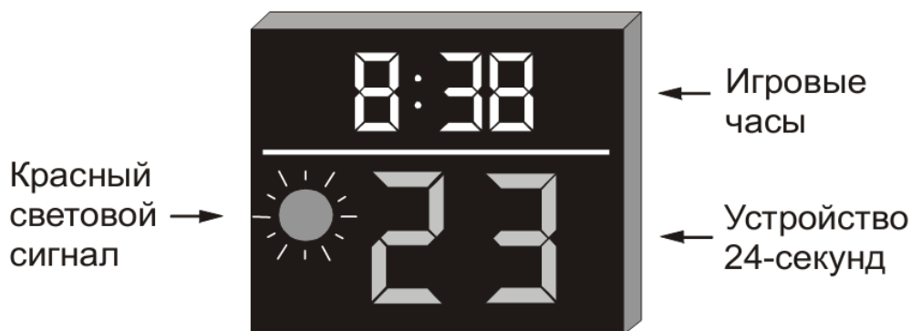
Рис. 9 Дисплей устройства двадцати четырех (24) секунд, дублирующие игровые часы и красный световой сигнал для Уровней 1 и 2 (пример оборудования)
